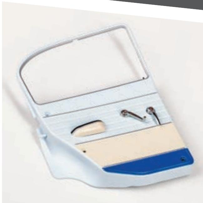
С лицевой стороны обивки установите ручку стеклоподъемника. На ось ручки с внутренней стороны обивки поместите шестерню ручки стеклоподъемника. Обратите внимание: на оси ручки и в отверстии шестерни имеются крепежные фаски, которые исключают проворачивание деталей относительно друг друга. Закрепите шестерню на оси при помощи винта 1,7×3 с пресс-шайбой (QP).
