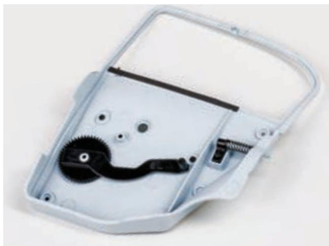
Установите тягу стеклоподъемника на нижнюю ось с внутренней стороны обивки задней левой двери. Убедитесь в легкости вращения шестерни на оси обивки. При заедании деталей сточите пластик изнутри отверстия шестерни тяги стеклоподъемника. Зафиксируйте детали на обивке винтом 2,0×3 с пресс-шайбой (RP).
