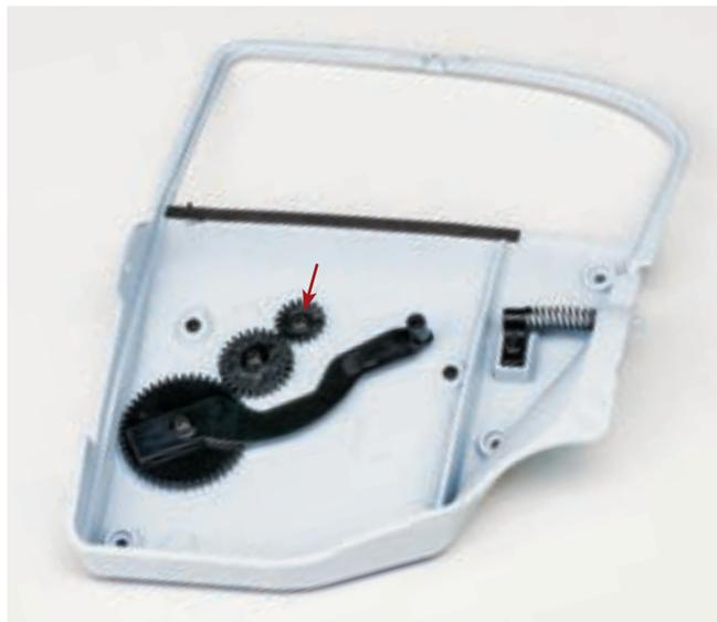
По окончании фиксации деталей проверьте подвижность шестерен на осях. Также убедитесь в работоспособности привода тяги стеклоподъемника от ручки. Установленные шестерни должны плотно входить в зацепление зубьями с соседними шестернями и исключать проскальзывание механизма привода. При необходимости подтяните или ослабьте крепежные винты шестерен.
