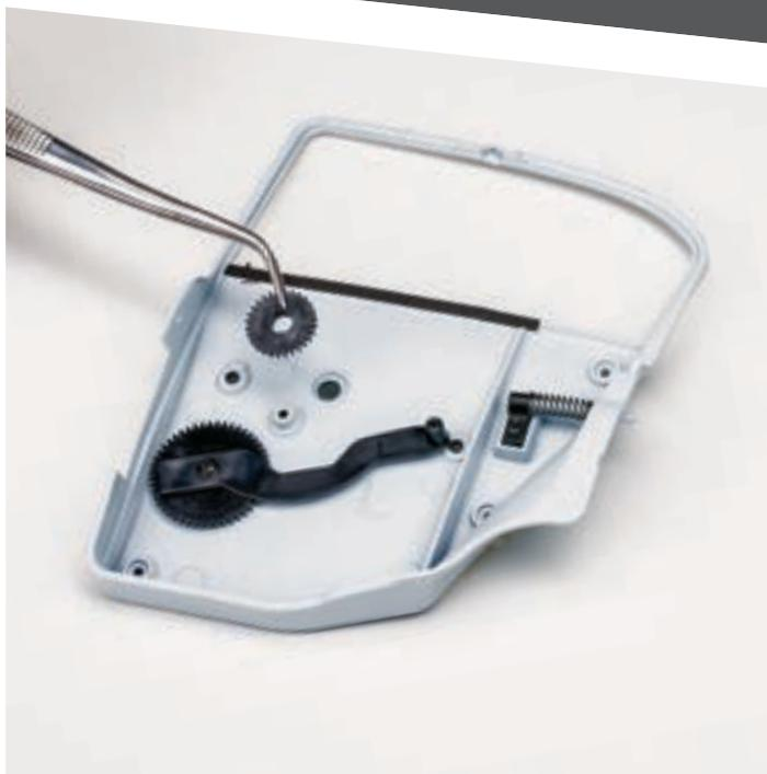
Установите промежуточную шестерню на ось, расположенную выше тяги стеклоподъемника, с внутренней стороны обивки двери. Зафиксируйте деталь при помощи винта 2,0×3 с пресс-шайбой (RP).
