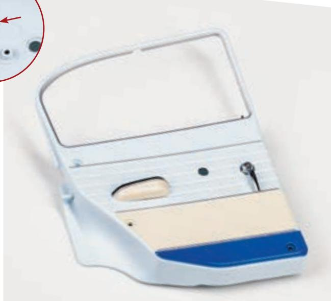
Установите внутреннюю ручку замка двери в средней части лицевой стороны обивки задней левой двери. Ручка должна быть направлена строго вниз. Зафиксируйте ручку с внутренней стороны обивки при помощи винта 1,7×4 (AP).
